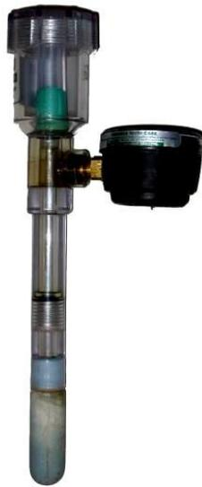
les tensions (valeur de dépression lue sur le manomètre du tensiomètre) augmentent lorsque le sol se dessèche et elles diminuent lorsque le sol est humide (0 cbars pour un sol saturé) .
